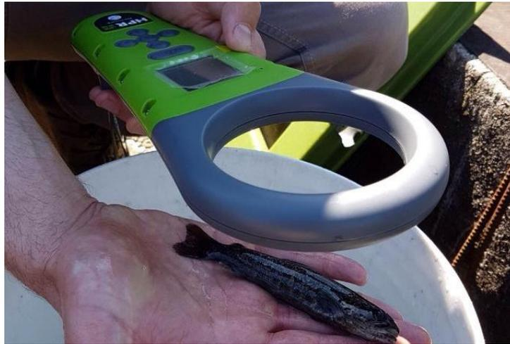
Foto 5: lettore PIT tag portatile utilizzato per valutare la presenza di un trasmettitore PIT tag all'interno di un pesce.
