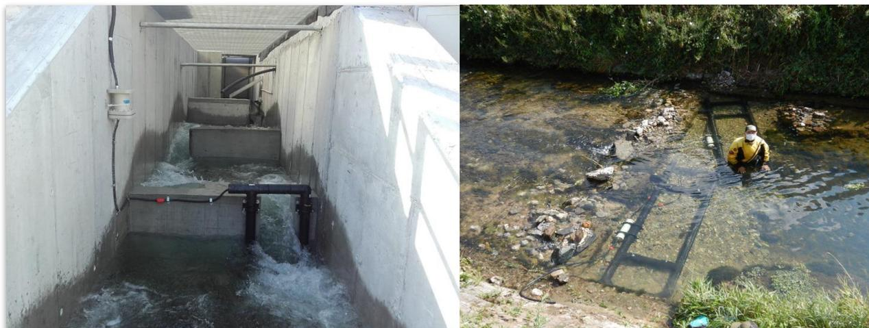
Foto 4: antenna fissa posizionata in un passaggio per pesci (sx). Antenna fissa HDPE posizionata sul letto del torrente Laveggio (dx).
